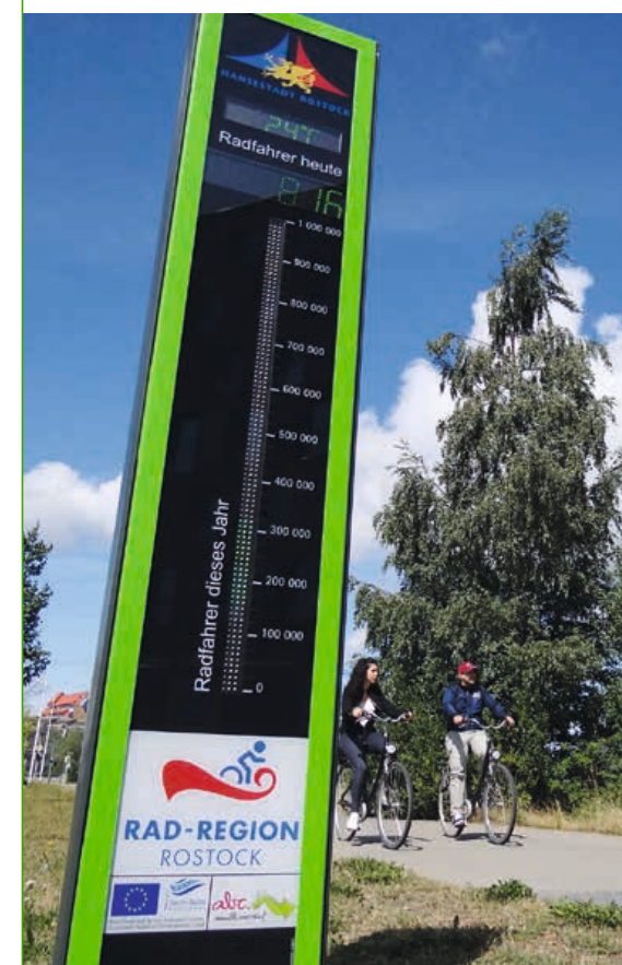
Das Fahrradbarometer der Hansestadt Rostock erfasst den Radverkehr mittels automatischer Zählstellen.
